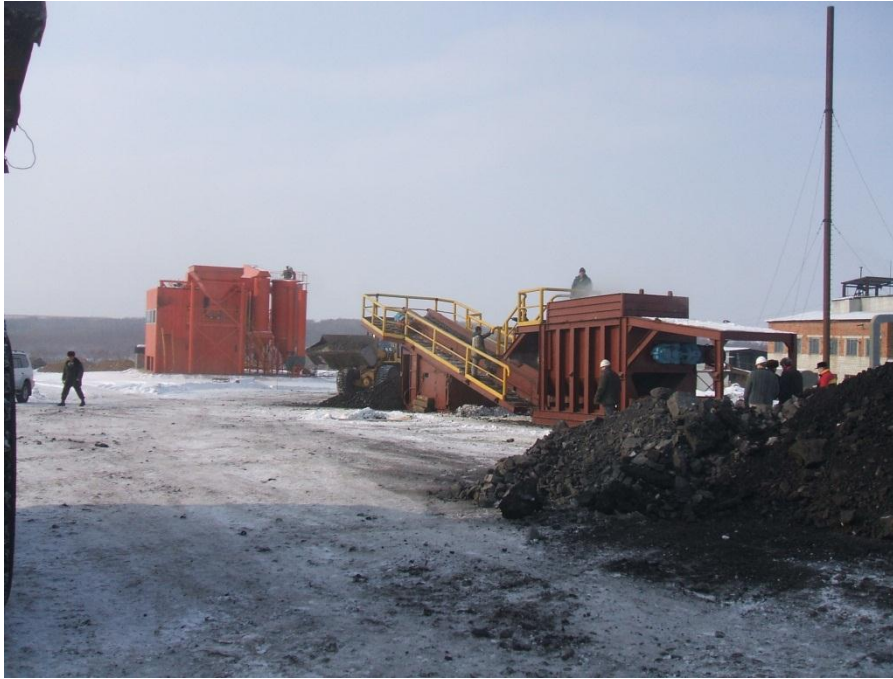
Рис. 6. Конструкция комплекса ДСКА производительностью 300 т/ч, с подачей продукта дробления на установку пневматического обогащения FGX производства КНР (Ш\У «Восточное» ОАО СУЭК)
