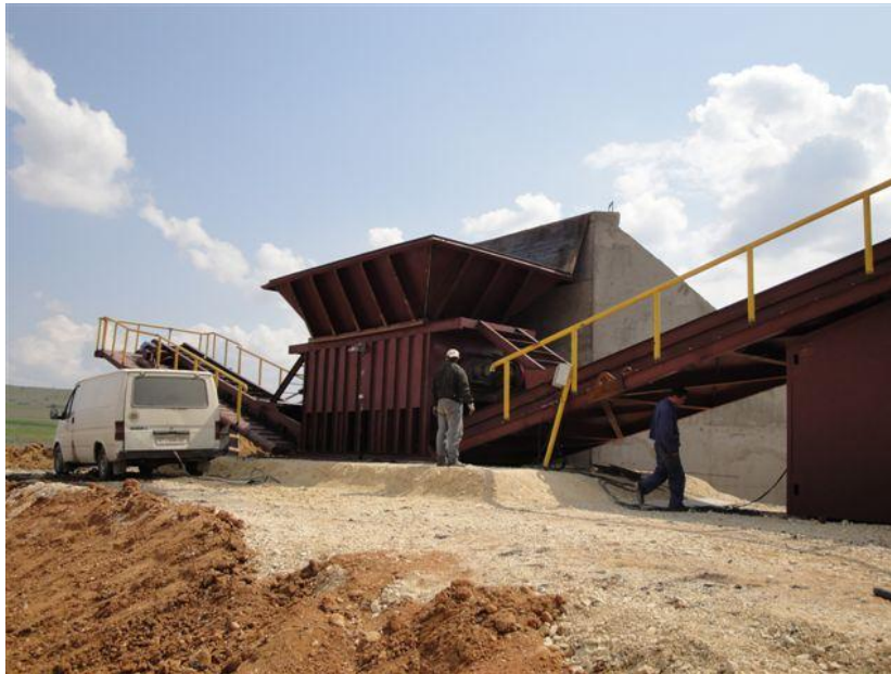
Рис. 4. Конструкция комплекса ДСКА производительностью 600 т/час для одностадийного дробления (до фракции 0-25 мм) и сортировки лигнита в варианте поставки компании “Bitola” (Республика Македония)
